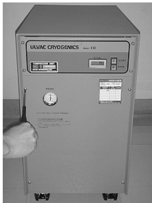
①前面パネルのネジを外してください。 *背面パネルのネジ及びジャムナットは緩めないでください。
