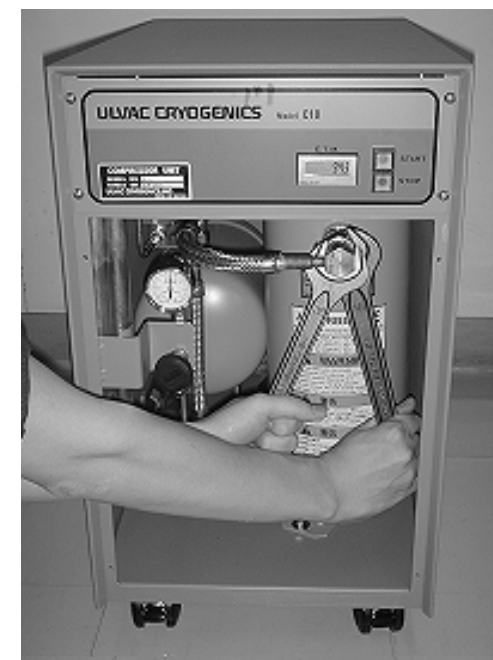
③アドソーバ出口に接続されているフレキホースを外してください。
