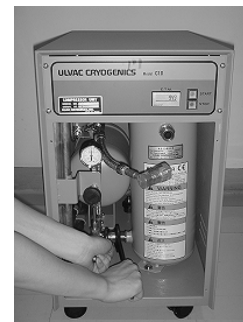
④アドソーバ入口に接続されているフレキホースを外してください。
