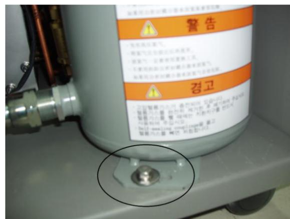
④アドソーバ取付けボルトを外して下さい。
