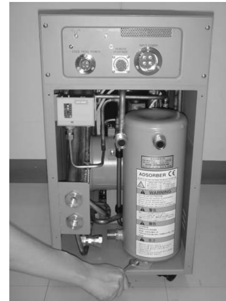
③アドソーバ取付けボルトを外してください。
