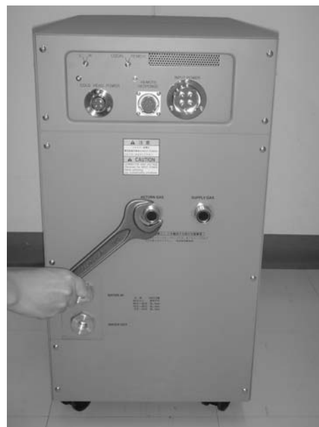
①ビス (M4、7本) とジャムナットを外し、後面パネルを外してください。
