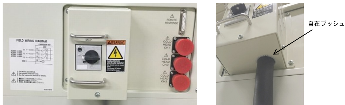
図 4-13 メインサーキットプロテクタのカバーを閉める
