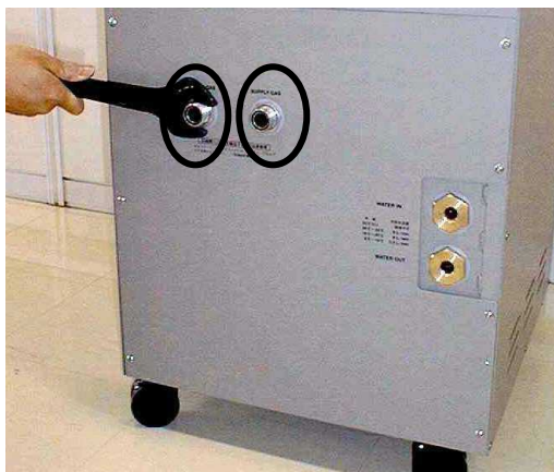
図 6-1 ヘリウムガス接続口のナット2個を外す
