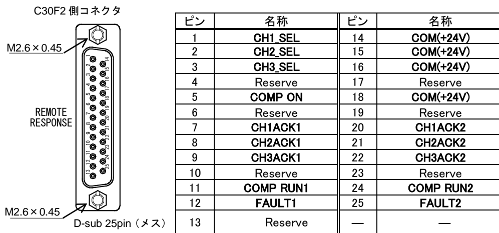
図 4-14 リモートコネクタのピン定義 - (リアパネルから見た図)
