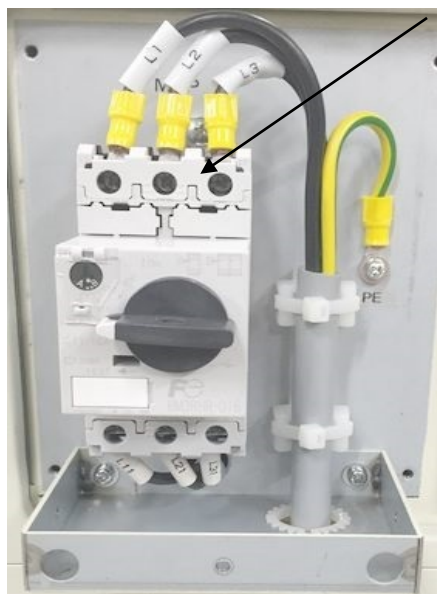
図 4-12 メインサーキットプロテクタ端子に電源線を接続
