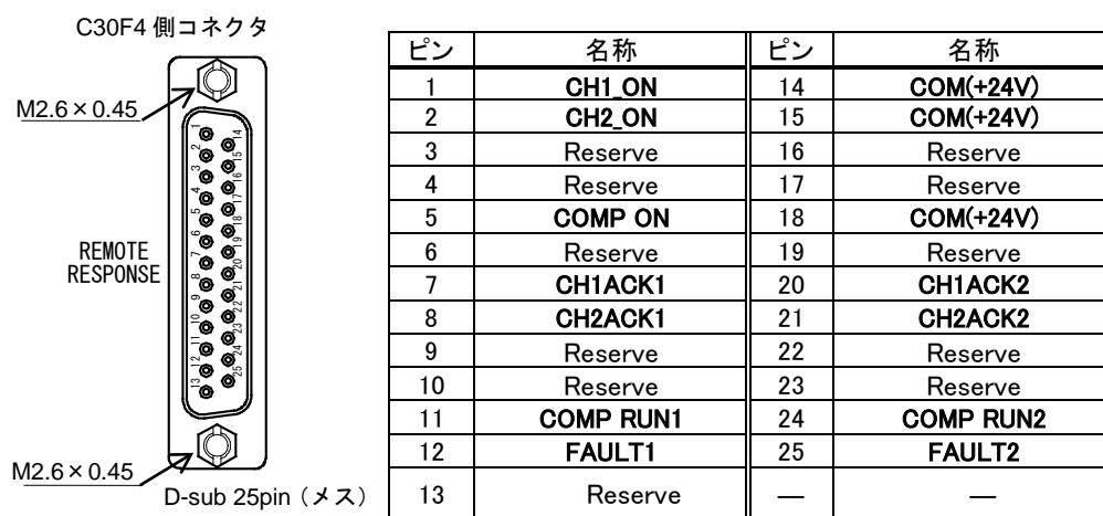
図 4-15 リモートコネクタのピン定義 - (リアパネルから見た図)
