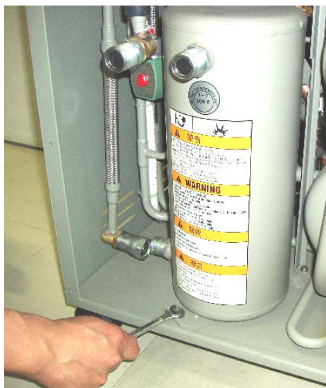
図 7-6 アドソーバ取付けボルトを外す
