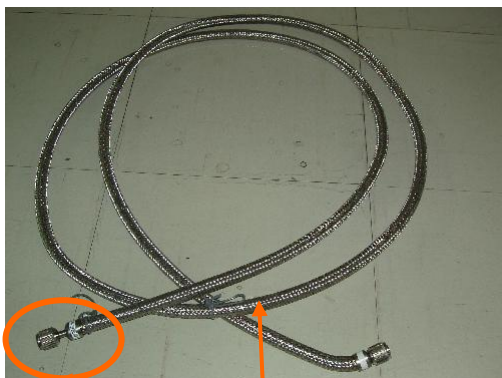
1/4 インチ フレア口 (コンプレッサへの接続側)
