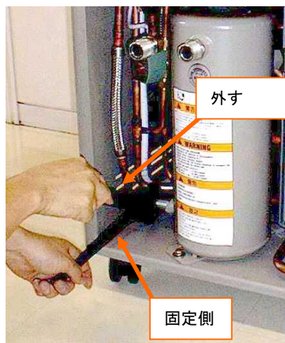
図7-4 セルフシールカップリングを外す
