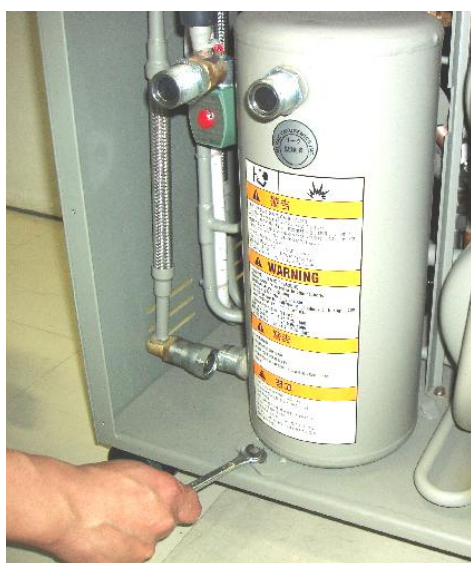
図7-6 アドソーバ取付けボルトを外す
