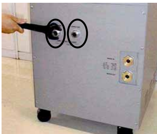
図 7-1 ヘリウムガス接続口のナット2個を外す 図 7-2 リアパネルのネジ7個を外す
