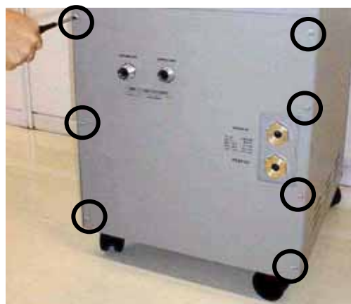
図 7-1 ヘリウムガス接続口のナット2個を外す 図 7-2 リアパネルのネジ7個を外す
