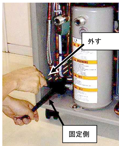
図 7-4 セルフシールカップリングを外す
