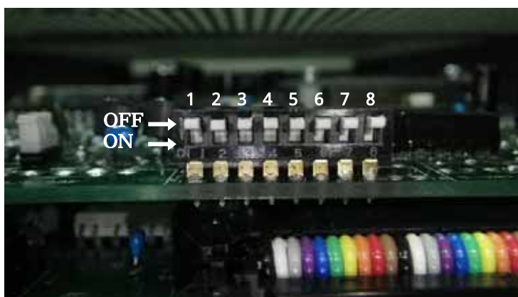
図 4-2 ディップスイッチの状態(デフォルト時)
