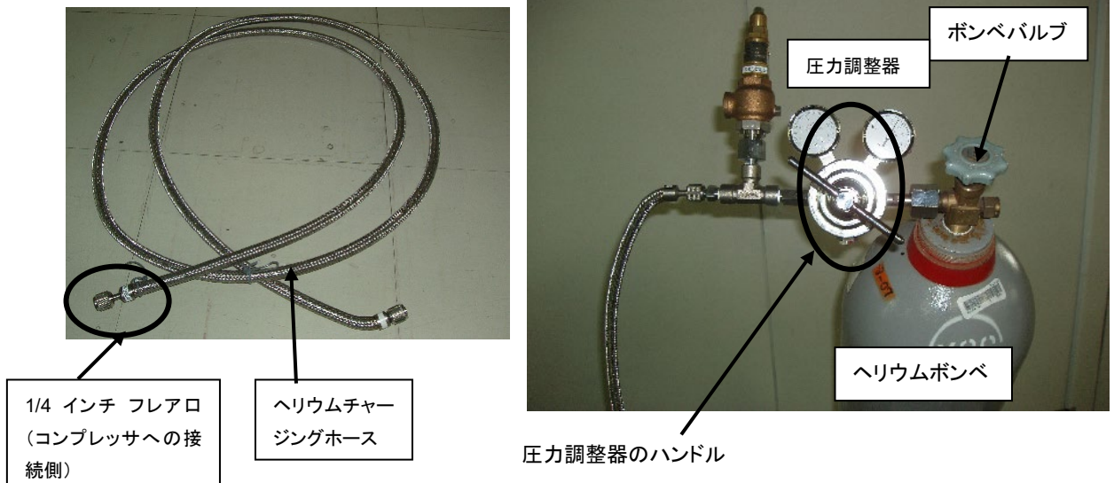
図 7-9 コンプレッサヘリウムガス補充のために準備するもの
