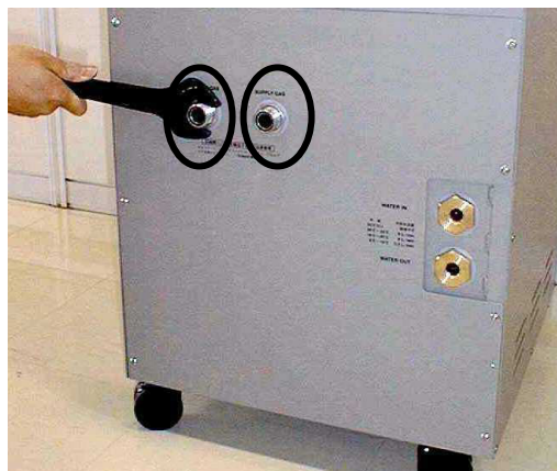
図 7-1 ヘリウムガス接続口のナット2個を外す(左)
