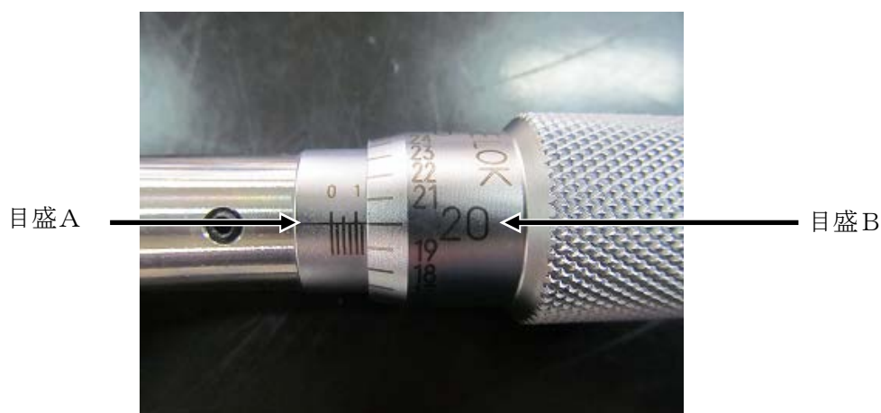
写真2. バルブの目盛の読み方
